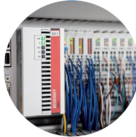
Das GRS550 besitzt eine moderne Schrittmotorsteuerung mit Überwachung aller Achsen per Encoder
