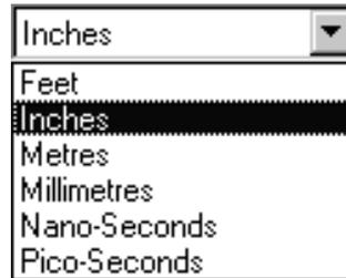
Das Feld **Units** spezifiziert die Einheit (Fuß, Zoll, Millimeter, Meter, Nanosekunden und Picosekunden) welche für die Felder Test From, Test To und Probe Length verwendet werden. Es definiert die Einheiten, in welcher alle Distanz- oder Zeitparameter der horizontalen Achse der angezeigten Kurvenform dargestellt werden.
