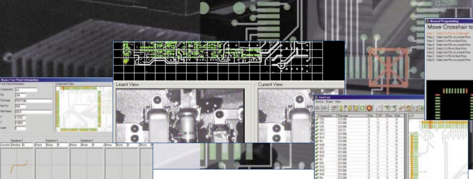
für das GRS500 sehr einfach, die Knotenimpedanzen und Charakteristiken einer Musterbaugruppe einzulernen. Diese "Gut-Daten" werden für den raschen und effizienten Test herangezogen. Das GRS ermöglicht auch einen Video-Bildvergleich der Baugruppe, indem eine Matrix hochauflösender Bilder für den späteren Vergleich aufgenommen wird.
