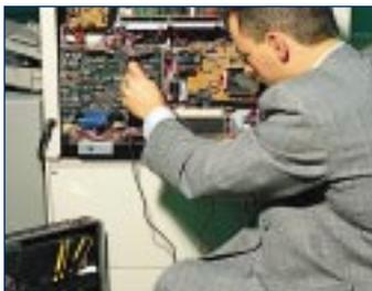
Zusätzlich zur hochempfindlichen Leiterbahn-Widerstandsmessung und Spannungsmessung bietet der Toneohm 950 eine non-invasive Strommessung in Leiterbahnen - ohne die Leiterbahn zu durchtrennen. Eine kontaktlose Stromfolger-Probe ermöglicht das Auffinden von Vcc-Masse-Schlüssen sowie von Busfehlern auf Speichersystemen oder auf Backplanes.
