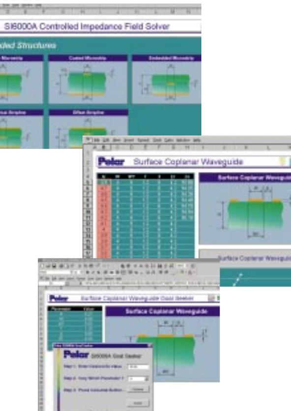
**SI6000A ist das Ergebnis von Anregungen hunderter Anwender der Polar CITS25 Impedanzberechnungssoftware. Neue Fieldsolver-Methoden der SI6000A Software erlauben die Darstellung der Impedanz über verschiedenen Parametern.**
