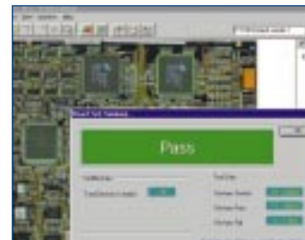
Der FT100s beruht auf dem Impedanzvergleich, um Sie bei der Fehlersuche zu unterstützen.
