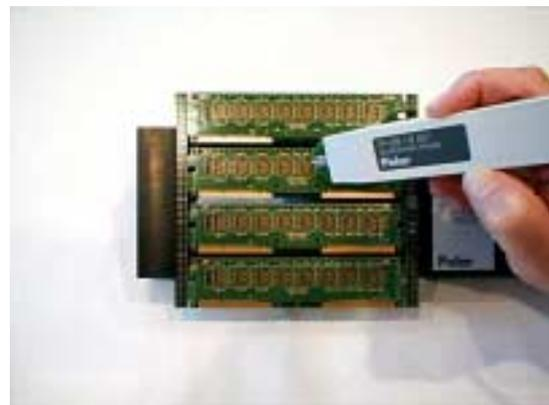
インピーダンス測定は TDR へ戻る最初の反射に左右されるため、ショート・トレースの測定時にはプローブのインピーダンスは被測定トレースのインピーダンスに一致(適合)されるべきです。例えば 75 トレースには IP75 プローブの使用がお勧めです。
