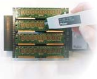
RIMM™モジュールへのプロービング
